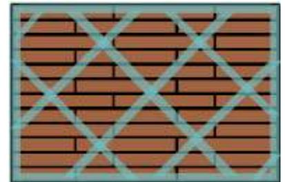
Plus de 64 m<sup>2</sup> : créer un quadrillage de bandes poissantes avec des cases de 4 mx 4 m
