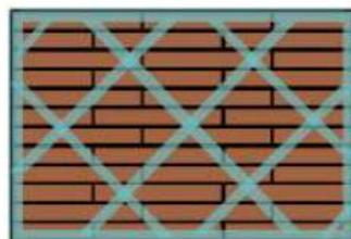
Plus de 64m<sup>2</sup>: appliquer une bande de poissant en quadrillage de 4/4m et en périphérie de la pièce
