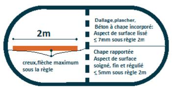
Sur support bois sans désaffleure, pose direct autorisée ≤ 3mm sous une règle de 2m et ≤ 5mm sous règle de 2m si enduit de sol, au-delà de ces tolérances non conformes
