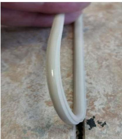
Die Fasern auf beiden Seiten der Fugen sind nicht sichtbar. Das bedeutet, dass die Fasern nicht richtig geschmolzen sind. (Temperatur zu niedrig oder Schweißgeschwindigkeit zu hoch). Schlechte Adhäsion zwischen Linoleum und Schmelzdraht
