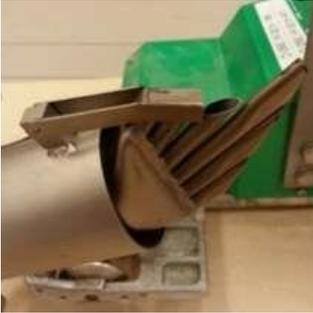
Unter Umständen kann es vorkommen, dass der Schmelzdraht am Andruckrad klebt. In diesem Fall wird vorgeschlagen die Klappe zu verschließen
