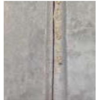
Eine außermittige Fräsung führt dazu, dass der Schmelzdraht von der Kante weggezogen wird.
