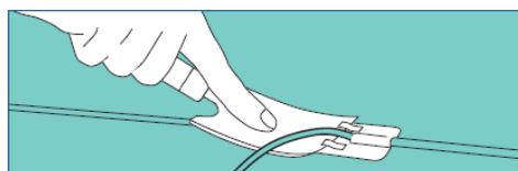
Figure 5 – Soudure à chaud : pré-arasement du cordon avec guide d'arasement
