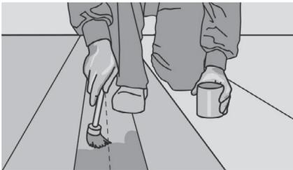
*Рис. 90.* Из-за толщины покрытия, острые внешние углы должны быть закруглены. Если нужно, используйте двойной слой клея на внешних углах. Покрытие должно быть прогрето феном с тыльной стороны, когда укладывается на угол. Клей наносится на ширину 150 мм на каждой стороне угла (см. рисунок).
