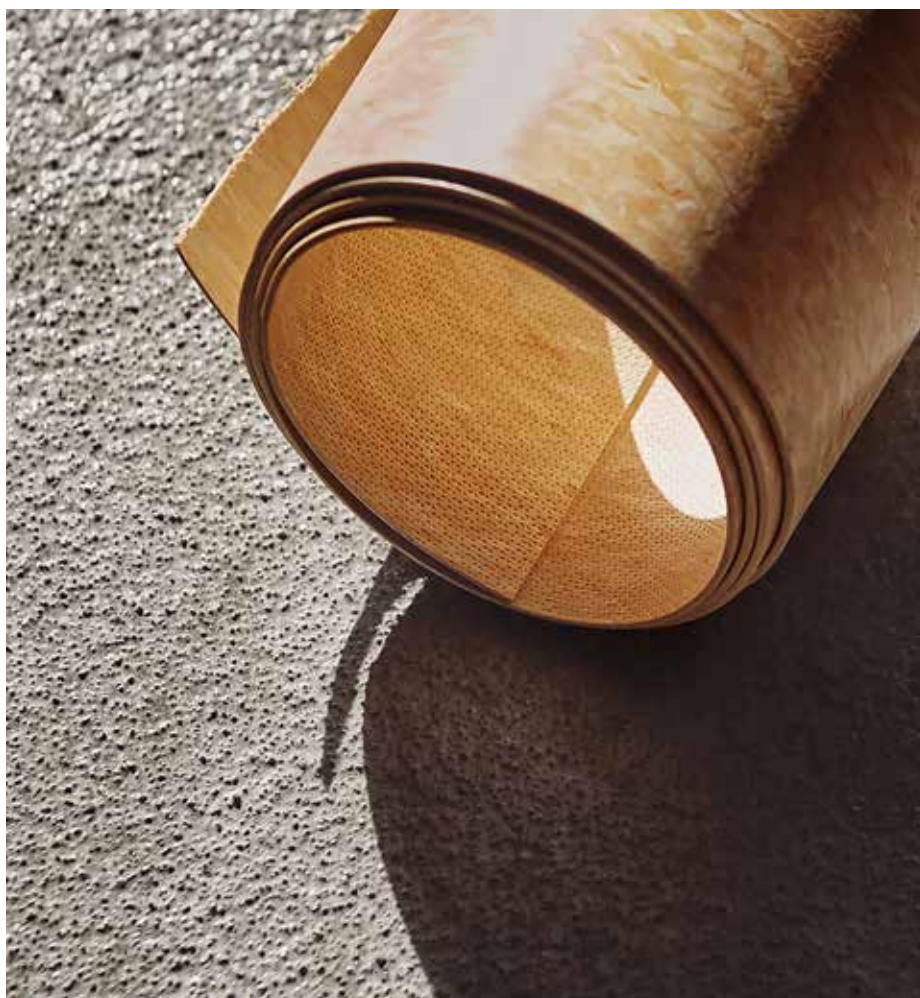
スウェーデンのRonnebyにあるリサイクルセンターでリサイクルを待つ単層塩ビ床材。
