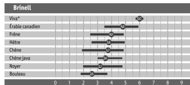
\*La gamme Viva présente un nombre Brinell élevé car la force de la bille Brinell est absorbée par la structure de la fibre haute densité. Viva n'est pas commercialisé en France.
